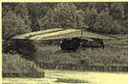
Brückenlegepanzer BIBER, der auf dem Fahrgestell vom Leopard 1 entwickelt wurde. Die Ausfahrbare Brücke ist 22 Meter lang.
